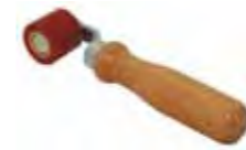
Прикаточный ролик шириной 28 мм из силикона, на подшипнике. Art.-Nr.: 5106977
